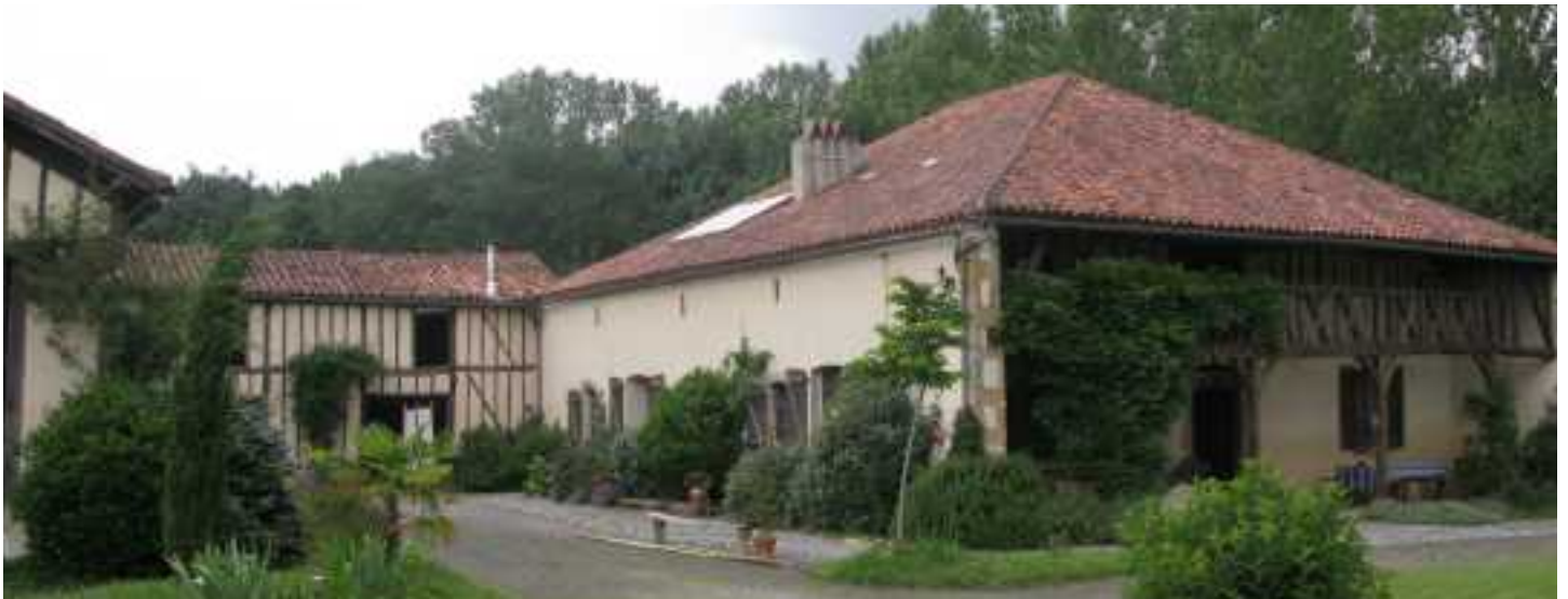
Borde de métayer. Les façades sud et est sont ouvertes. Un débord de toit crée une terrasse ombragée à l'est, aussi appelée "amban".
