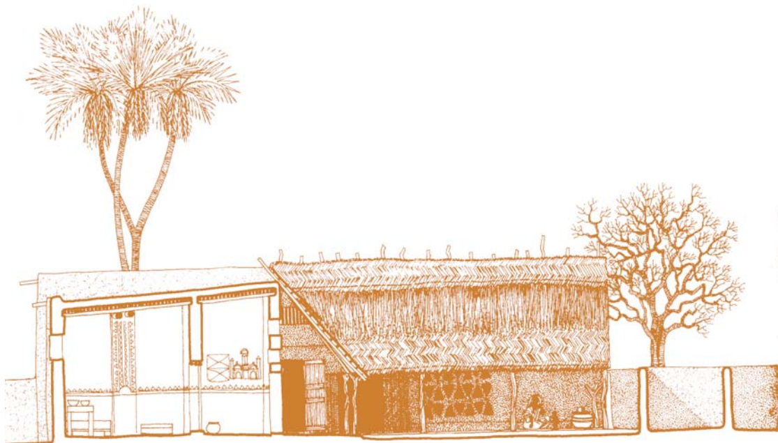
Dessins de coupe et élévation sur une maison Toucouleur à toit terrasse / Source : Maisons sénégalaises – habitat rural 1. Patrick Dujarric. UNESCO Établissements humains et environnement socio-culturel, 1986
