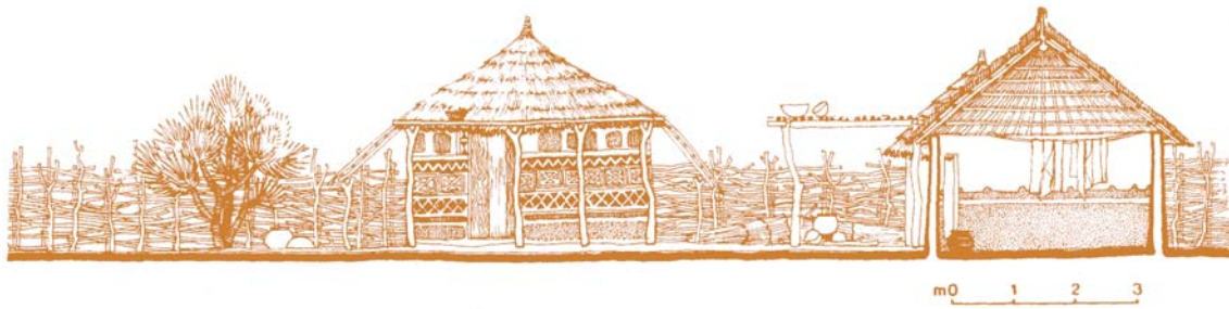
Dessin de coupe et élévation sur une concession Toucouleur – cases à toit pointu / Source : Maisons sénégalaises – habitat rural 1. Patrick Dujarric. UNESCO Établissements humains et environnement socio-culturel, 1986
