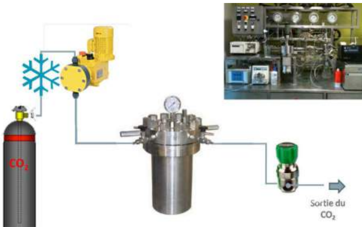
Figure 21 : Représentation schématique du dispositif de séchage par CO 2 -SC « gros volume »
