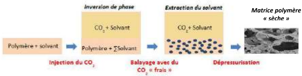
Figure 17 : Schéma de principe du procédé séparation de phase utilisant le CO 2 -sc comme anti-solvant
